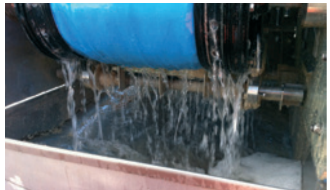
Bild 3: Entwässerung im Z300A
