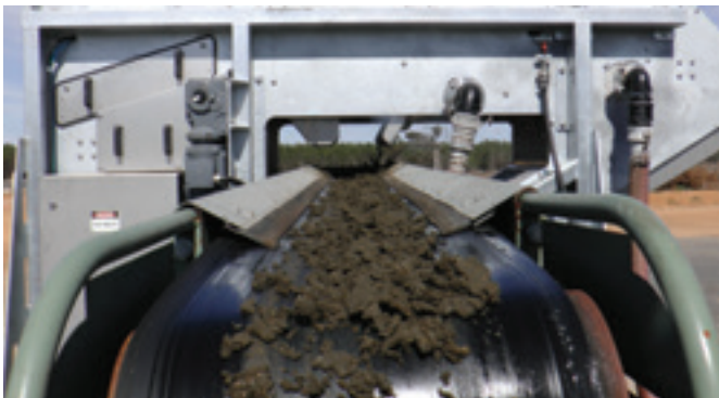
Bild 3: Feststoffe nach dem Z300A auf dem Förderband.
