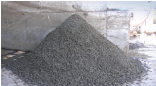
Bild 1: Trockener Schlamm nach Z-Filter
