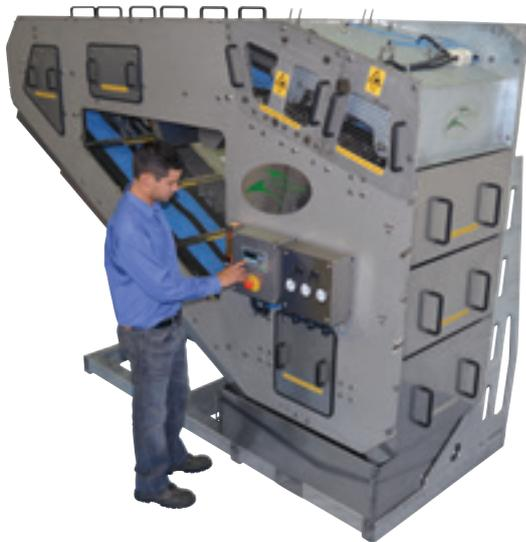
Im abwärts gerichteten, ersten Entwässerungsbereich fließt das Filtrat über das Gewebe und ein Teil des Filtrats wird hier bereits abgetrennt. Dieser "Waschvorgang" hält das Gewebe frei und verhindert Verstopfung durch Schwebstoffe.
